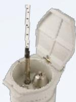
El cierre artesiano se utiliza en lugar de una tapa en el punto de medición, adaptado mediante una rosca de fijación. La parte inferior asegura que el cierre sea seguro, en caso de caída del nivel del agua en el punto de medición. El nivel del agua puede ser medido en relación con la fluctuación atmosférica.
